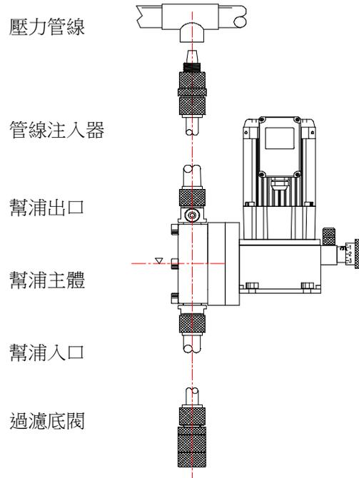
因為幫浦馬達、減速機、曲軸等機械系統統計上故障機率很低，除非您很確定機器已無法運轉(拆下幫浦頭觀察隔膜已不會動作，如此須送廠維修)，否則最常見之原因是
